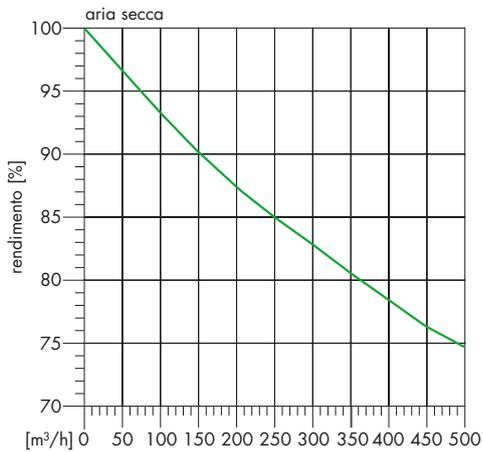
EFFICIENZA IN FUNZIONE DEL CALORE DI CONDENSAZIONE
