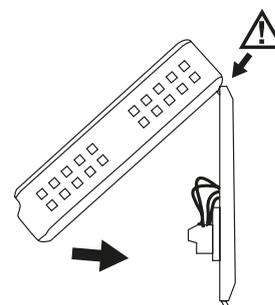
Per montare correttamente il display, allineare le due sporgenze sulla parte superiore della piastra con i fori sul retro del display.
