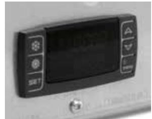
Elettronica di controllo con microprocessore, comprensiva di display LCD.
