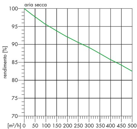
Efficienza in funzione del calore di condensazione
