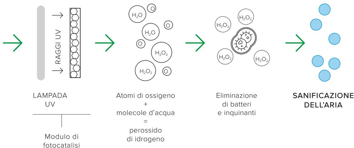
\*schema a puro titolo esemplificativo di un generico processo di fotocatalisi.
