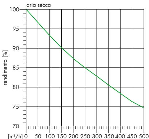
EFFICIENZA IN FUNZIONE DEL CALORE DI CONDENSAZIONE
